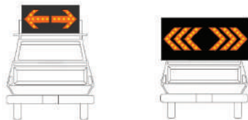
Figura 27 - Seta Iluminada acoplada a veículo
