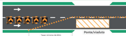
Figura 34 - Exemplo de Uso de Barreira Provisória em Obra de Recuperação/alargamento de pontes e/ou viaduto
