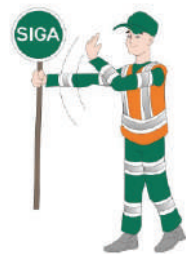
Figura 44 - O Operador mantendo sinal de “SIGA” voltado para o fluxo de veículos e gesto de início de circulação
