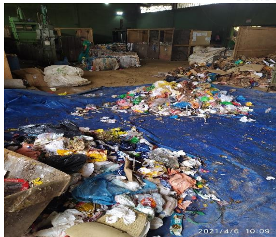
Figura 12 - Retirada das duas partes do primeiro quarteamento.
