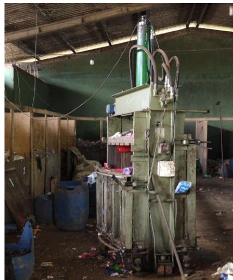
Figura 32 - Prensa para enfardar os materiais.
