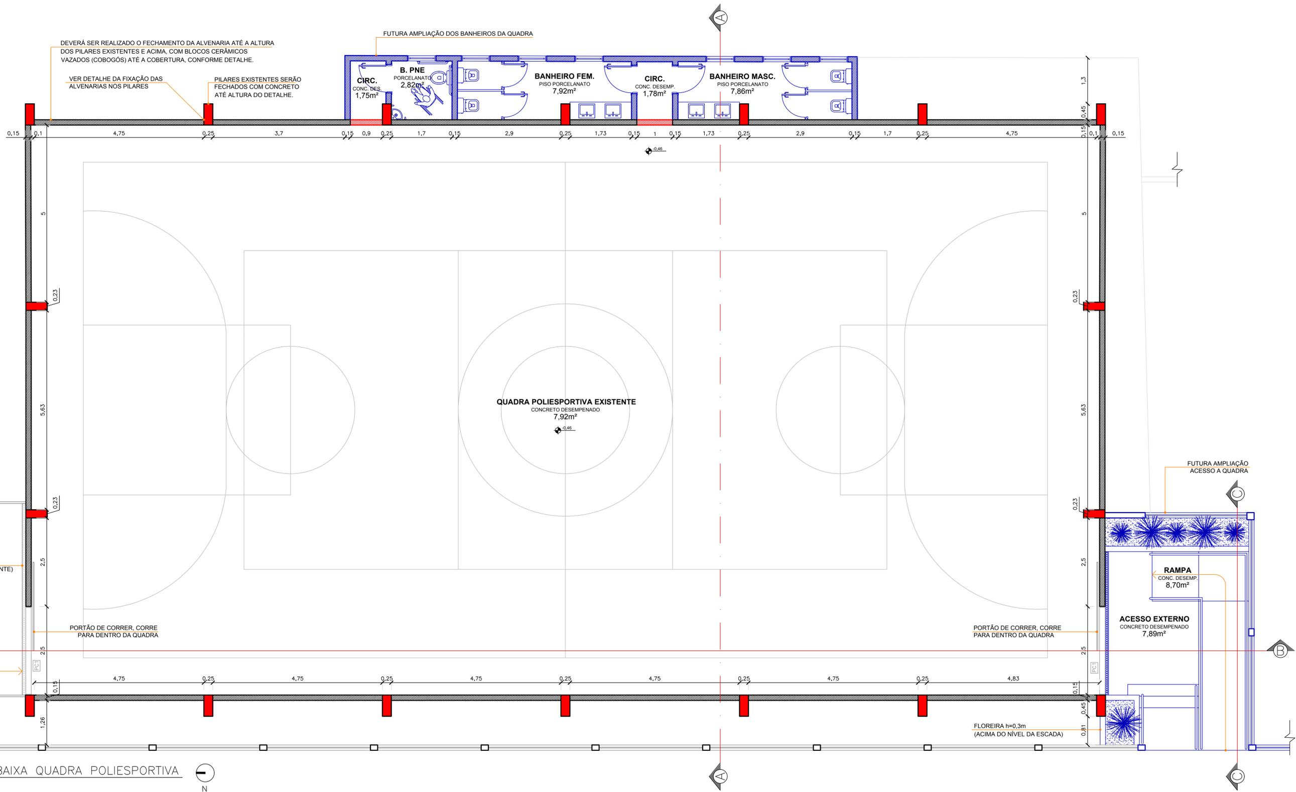
DEVERÁ SER REALIZADO O FECHAMENTO DA ALVENARIA ATÉ A ALTURA DOS PILARES EXISTENTES E ACIMA, COM BLOCOS CERÂMICOS VAZADOS (COBOGÓS) ATÉ A COBERTURA, CONFORME DETALHE.
